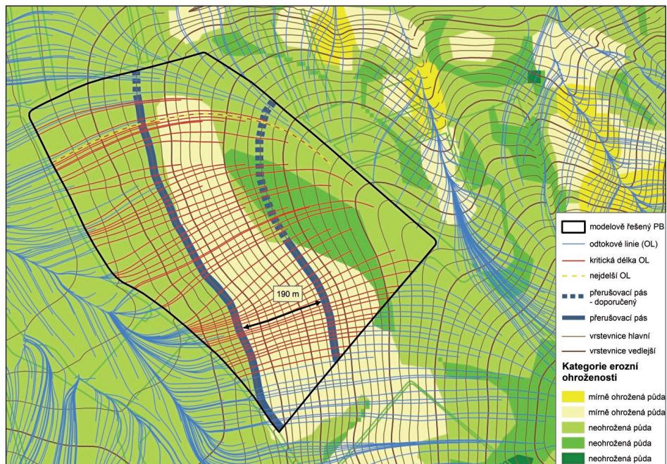
Obr. 2.7 Přerušovací pásy na PB/DPB se sklonitostí nad 5° (přerušované zobrazeno doporučené opatření)
