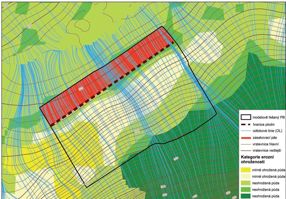
Obr. 2.11 Úzkořádková plodina plnící funkci zasanovacího pásu
