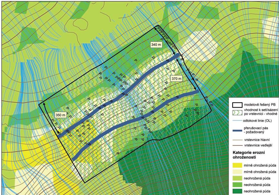
Obr. 2.24 Setí / sázení po vrstevnici doplněno přerušovacím pásem na PB/DPB s průměrnou sklonitostí nad 5°
