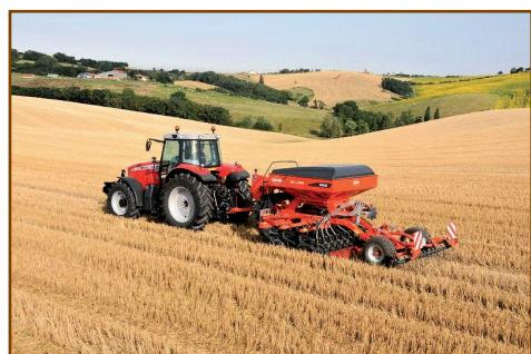
Obr. 3.8 Výsev kukuřice bezorebným secím strojem do rostlinných zbytků předplodin
